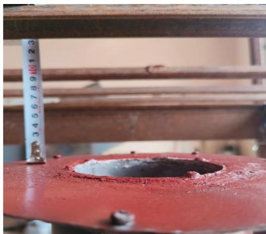
Рисунок 94 – Расстояние от плоскости реза до диффузора-ограничителя
