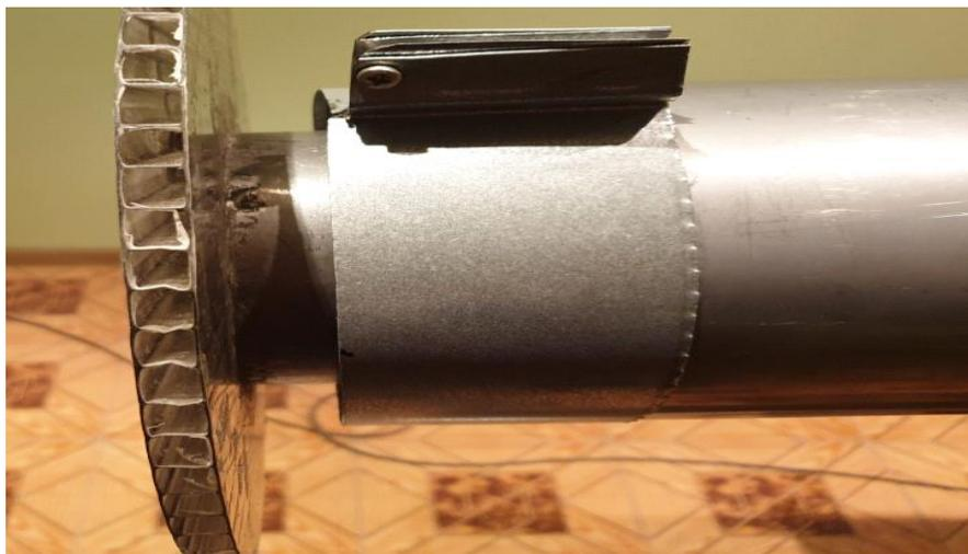
Рисунок 74- Раздающее отверстие коаксиального отсоса
