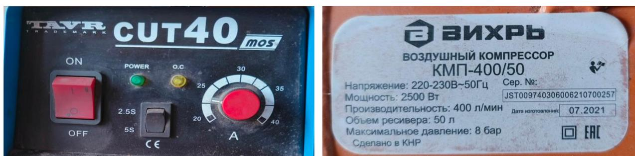
Рисунок 93 – плазморез TAVR марки CUT40 mos фирмы TAVR и компрессор марки КМП-400/50 фирмы Вихрь
