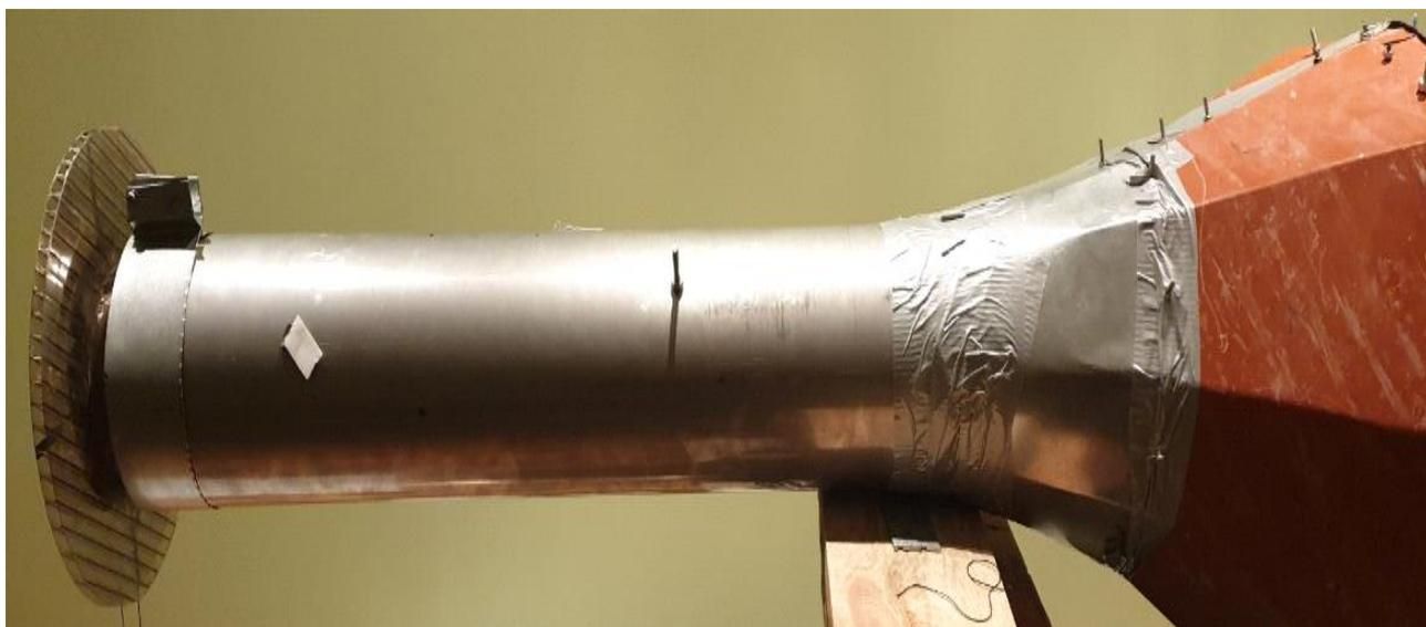
Рисунок 73– Коаксиальное вытяжное устройство, вид сбоку
