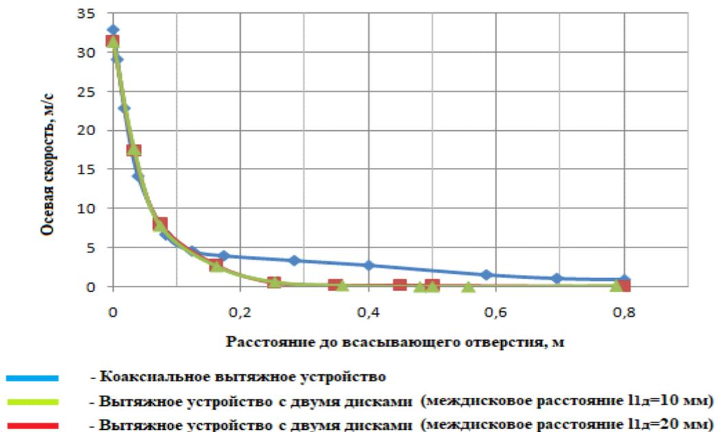
Рисунок 68- График осевых скоростей коаксиального вытяжного устройства и вытяжного устройства, с двумя дисками,  $Q_B=1000 \text{ м}^3/\text{ч}$
